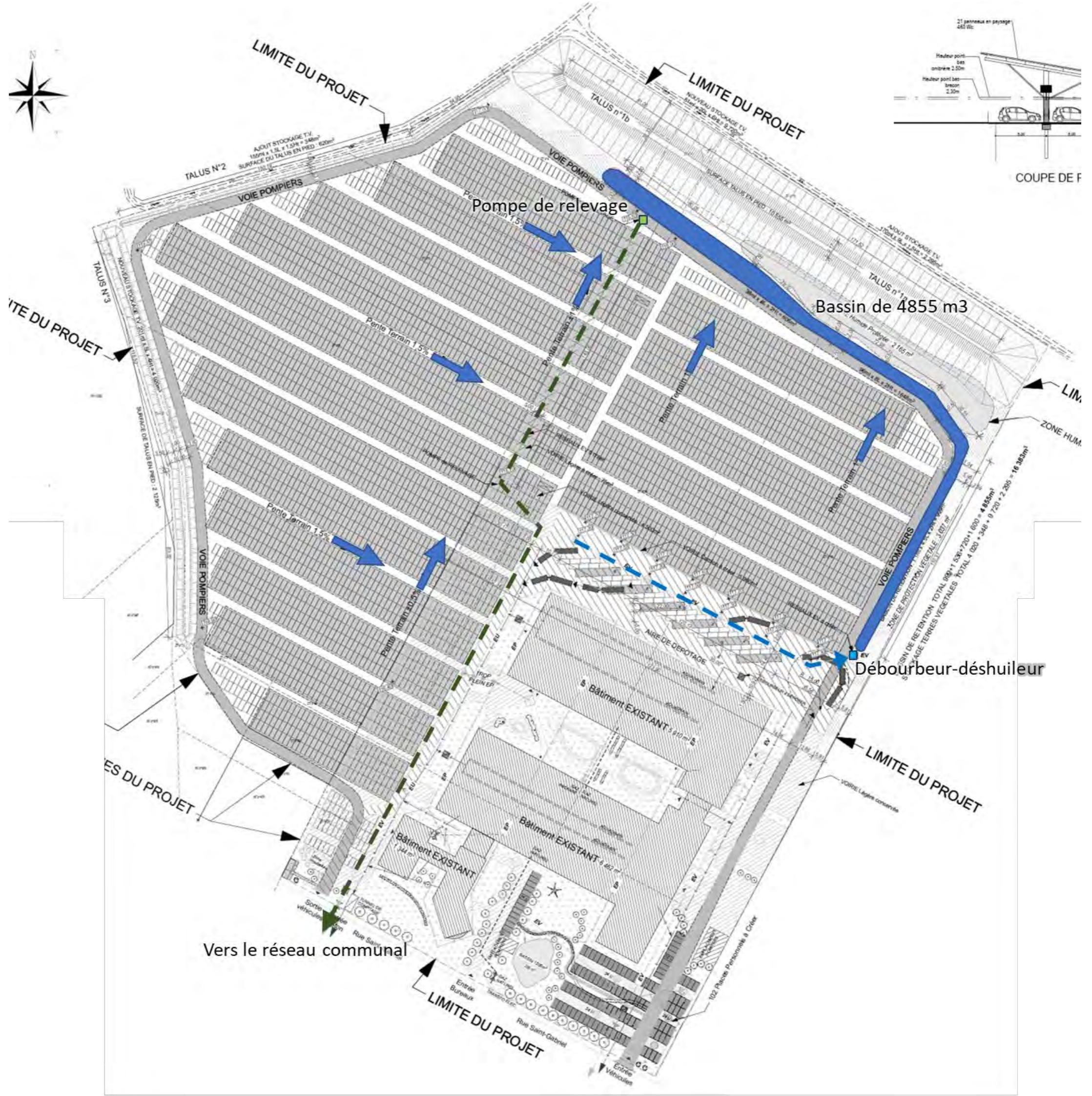
Figure 175 : Circuit des eaux pluviales à l'état final
